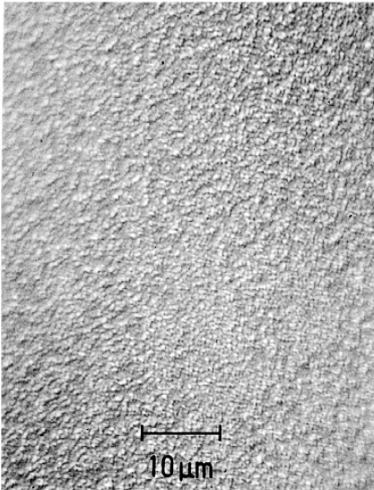
Surface GaAs (111)B nominale après préparation UVOCS et désoxydation in situ ( M.Opt. ) (1)
